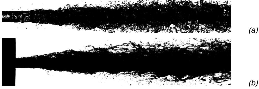
Figure 1- (a) Image simulée d'un spray numérique en utilisant l'optique géométrique, (b) Exemple d'image expérimentale.
